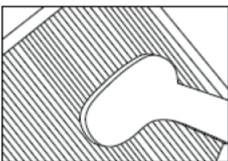
Wyczyścić **filtr wstępny**, **filtr z węglem aktywnym** i **filtr True HEPA H13** ostrożnie przy pomocy szczotki lub odkurzacza. W ten sposób większe części kurzu, takie jak kłaczki, włosy i łupież zwierząt domowych, mogą zostać usunięte z filtra.
