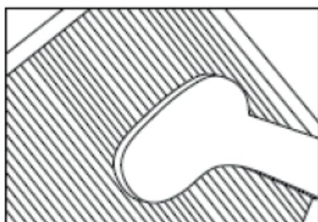
Аккуратно очистите фильтр предварительной очистки, фильтр с активированным углем и фильтр True HEPA H13 щеткой или пылесосом. Так из фильтров можно удалить большие частицы пыли, волосы и перхоть домашних животных.
