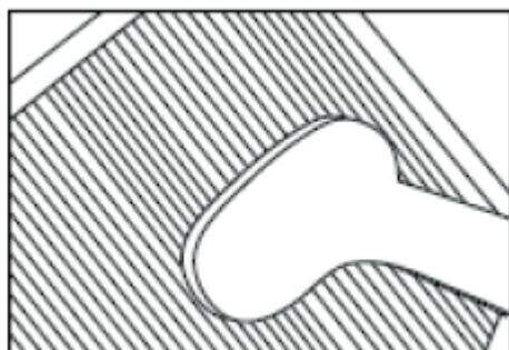
Reinigen Sie den **Vorfilter**, den **Aktivkohlefilter** und den **True HEPA H13-Filter** sorgfältig mit einer Bürste oder Ihrem Staubsauger. Auf diese Weise können größere Staubpartikel wie Flusen, Haare und Hautschuppen von Haustieren aus dem Filter entfernt werden.
