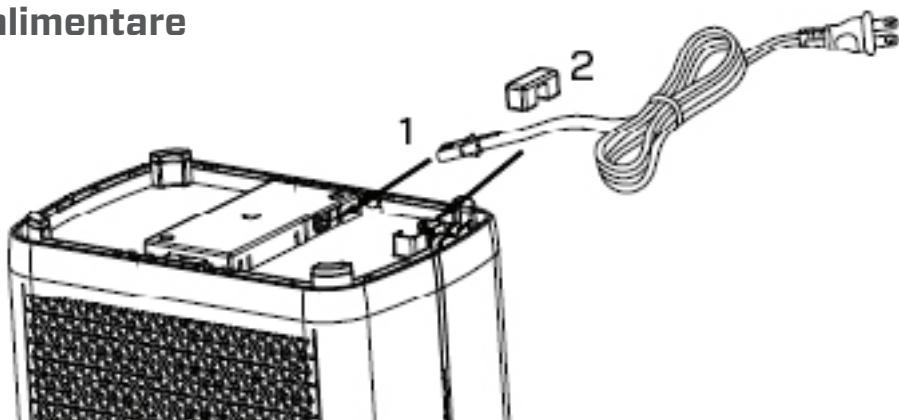
1. Scoateți adezivul din cablul de alimentare din partea inferioară a dispozitivului și introduceți capătul cablului de alimentare în priza din partea inferioară a dispozitivului (după cum se arată în figura 1).
