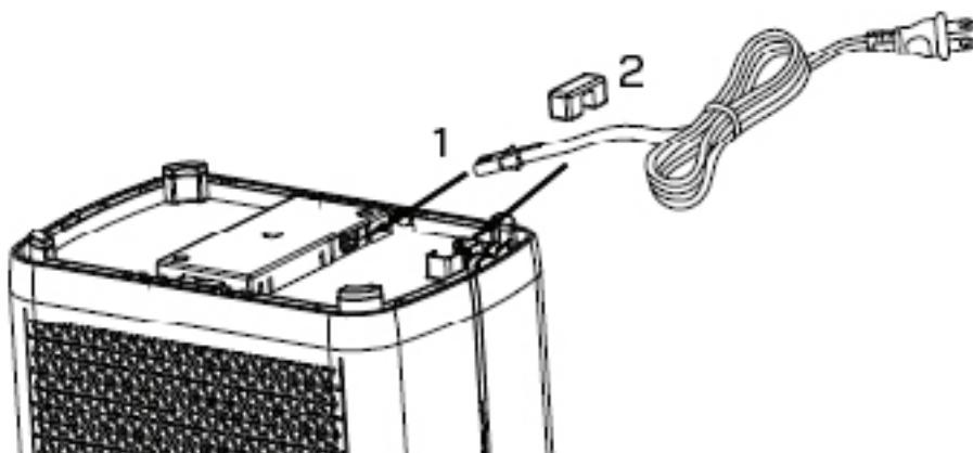
1. Verwijder de kabeldoorvoer (afbeelding 2) aan de onderkant van het apparaat en steek het uiteinde van het netsnoer in het stopcontact aan de onderkant van het apparaat (zoals weergegeven in afbeelding 1).
