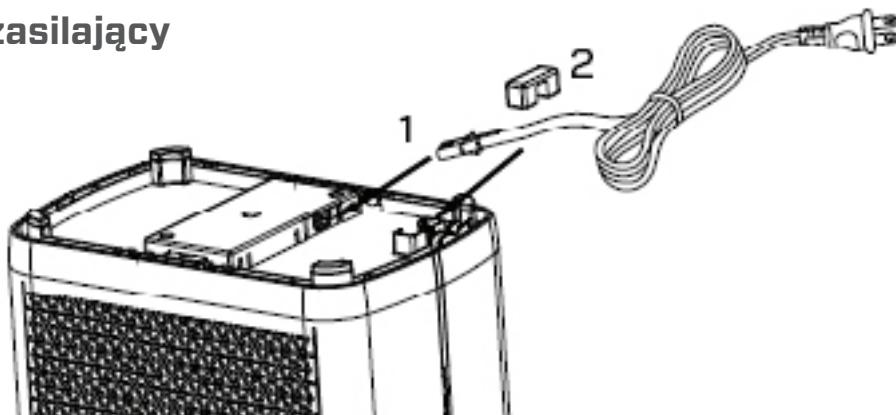
1. Usunąć klej przewodu zasilającego ze spodu urządzenia i włożyć jego koniec w gniazdo na spodzie urządzenia (jak pokazano na rys. 1).
