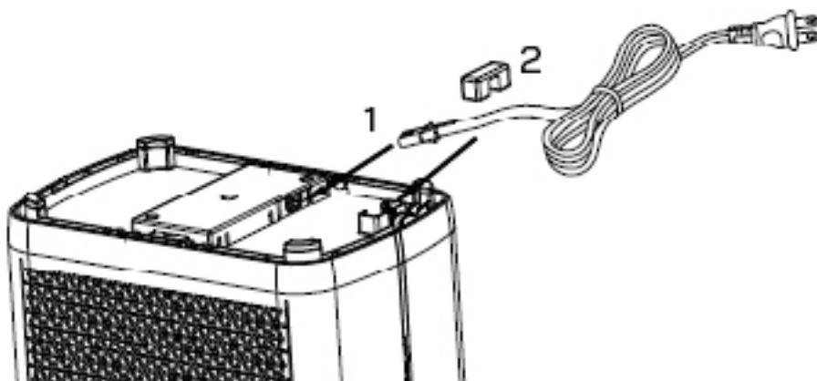
1. Entfernen Sie den Kleber für das Netzkabel von der Unterseite des Geräts und stecken Sie das Ende des Netzkabels in die Buchse an der Unterseite des Geräts (wie in Abbildung 1 dargestellt).
