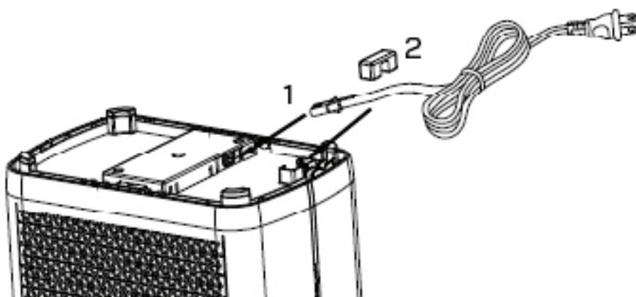
1. Attīriet elektrības kabeli ierīces apakšā no līmes un ievietojiet elektrības kabeļa spraudni kontaktligzdā ierīces apakšdaļā (kā parādīts 1. attēlā).
