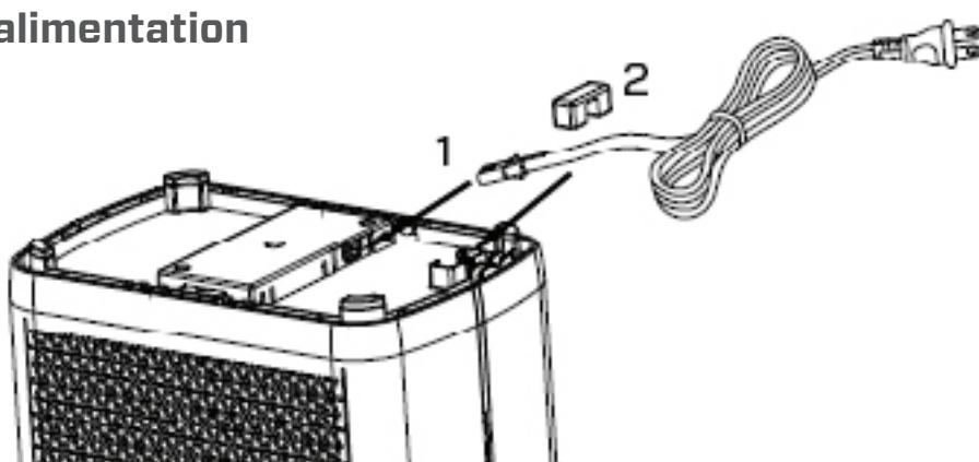
1. Retirez la colle du cordon d'alimentation dans le bas de l'appareil et insérez l'extrémité du cordon d'alimentation dans la prise située au bas de l'appareil (comme illustré à la figure 1).
