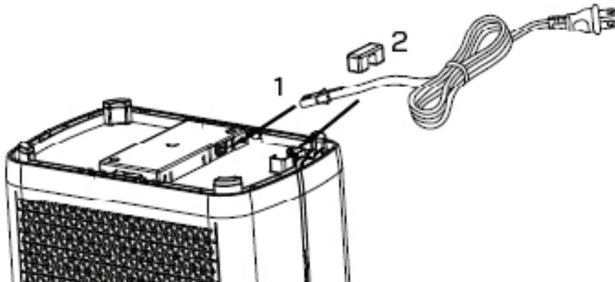
1. Odlepte napájecí kabel ze spodní části zařízení a zapojte konec napájecího kabelu do zásuvky ve spodní části zařízení (viz obrázek 1).
