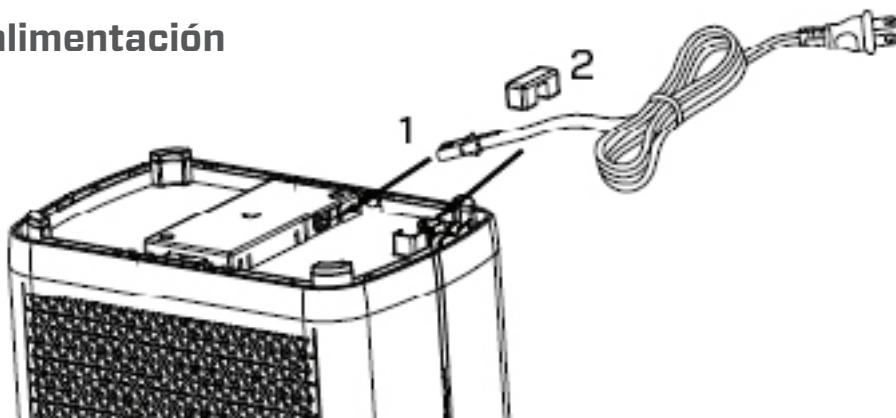
1. Retire el pegamento del cable de alimentación de la parte inferior del aparato e introduzca el extremo del cable en la toma situada en la parte inferior del aparato (como se muestra en la figura 1).
