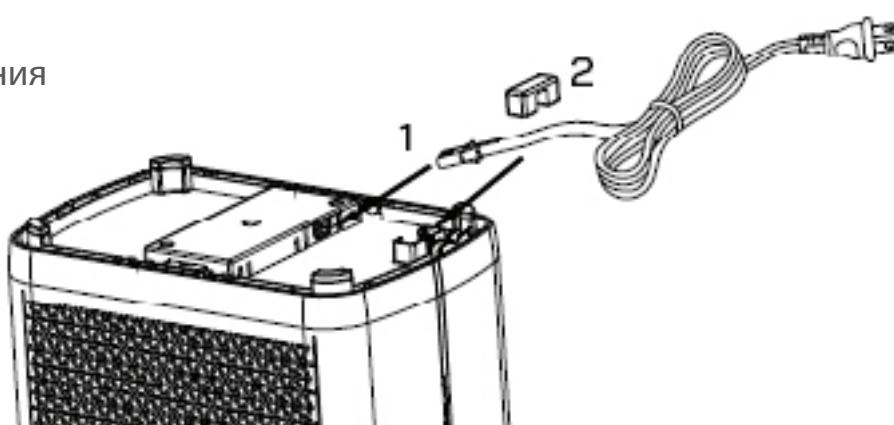
1. Удалите клей шнура питания с нижней части устройства и вставьте конец шнура питания в гнездо в нижней части устройства (как показано на рисунке 1).
