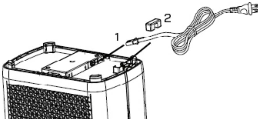
1. Eemaldage toitejuhtme liim seadme põhjast ja pange toitejuhtme ots seadme põhja asuvasse pessa (vt joonist 1).
